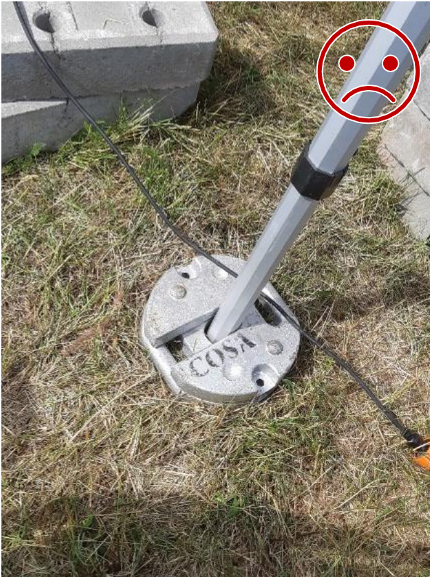
Kuva 1 EI NÄIN. Painojen lukitus toisiinsa puuttuu. Painot irtoavat painovoimaisesti, eivätkä pysy tolpan ympärillä tuulen ravistellessa telttää.
