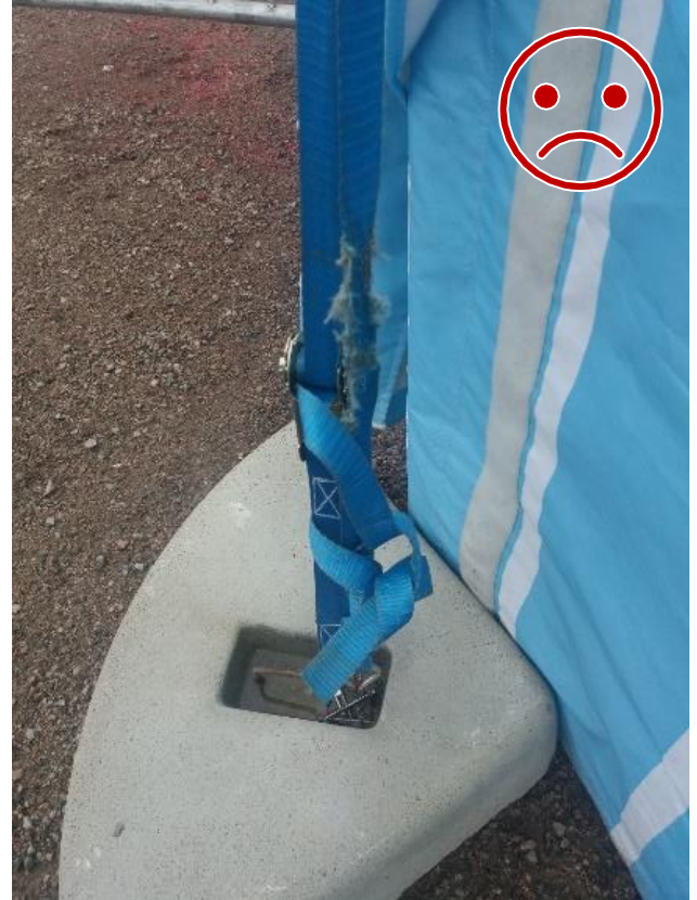
Kuva 10 Ei NÄIN. Kuormaliina on kulunut.
