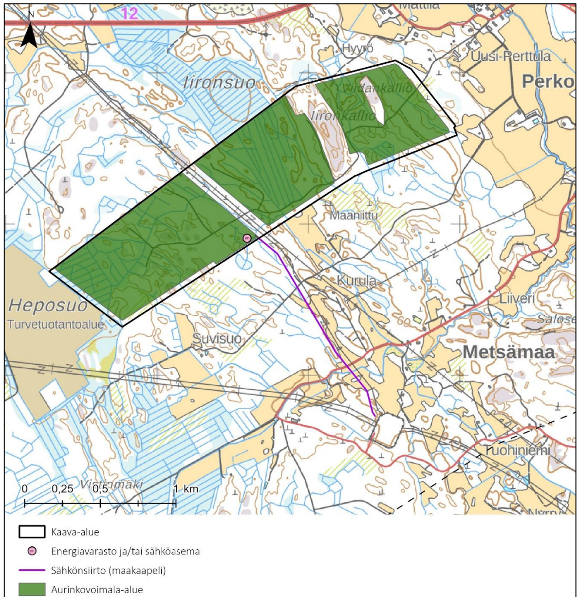
Kuva 7.1. Karsitun aurinkovoimalan yleispiirteinen suunnitelma.
